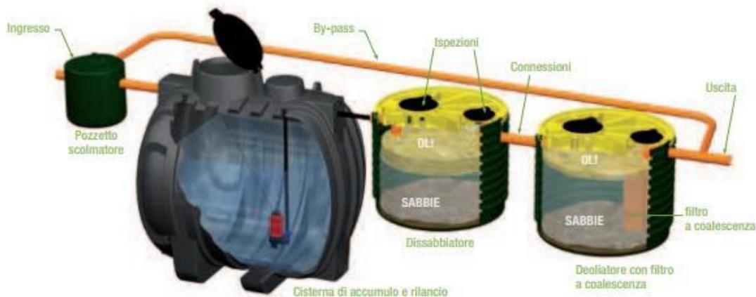
Figura 88: Schema tipo di impianto di trattamento acque di prima pioggia
