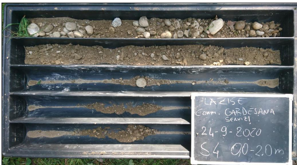
Foto cassetta con litologie del sondaggio S4
