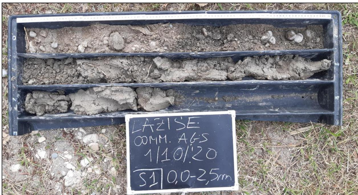
Foto cassetta con litologie del sondaggio S1
