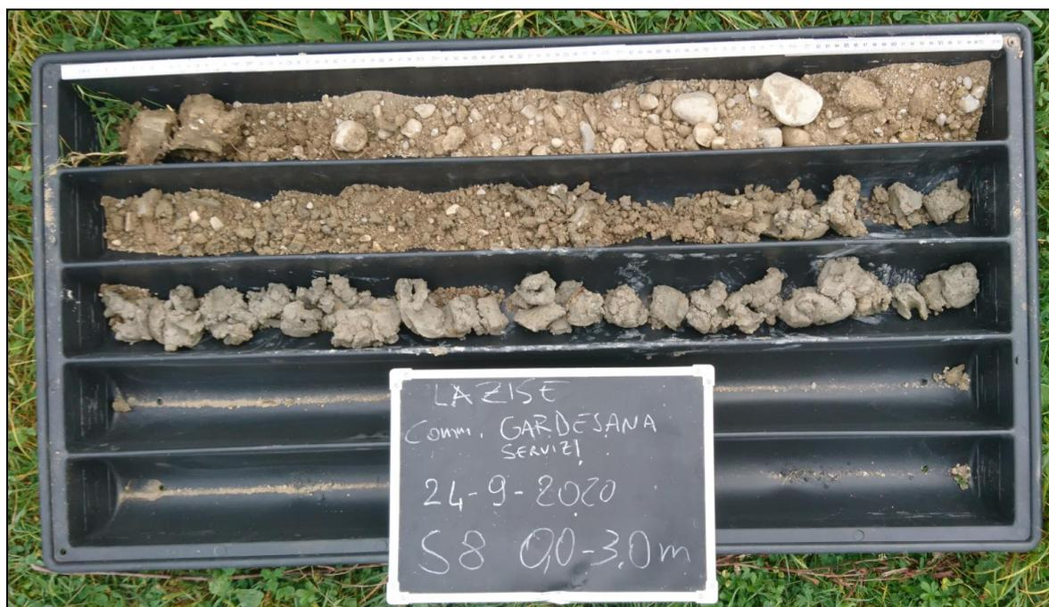
Foto cassetta con litologie del sondaggio S8
