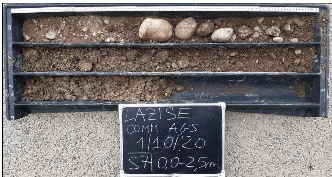
Foto cassetta con litologie del sondaggio S7
