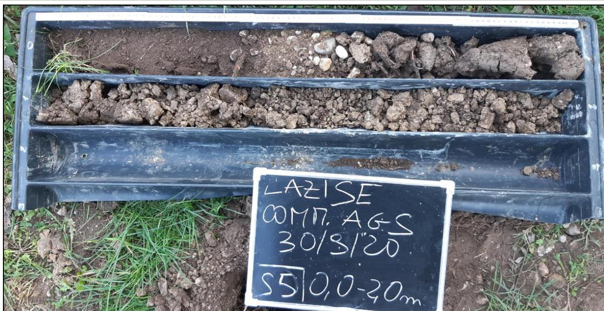
Foto cassetta con litologie del sondaggio S5
