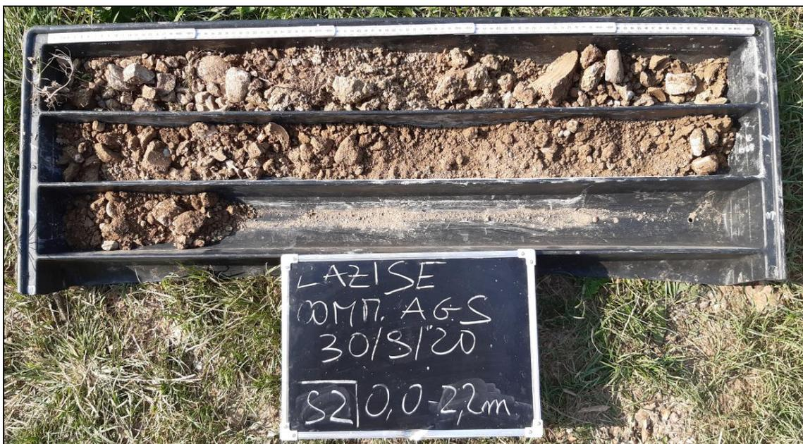
Foto cassetta con litologie del sondaggio S2
